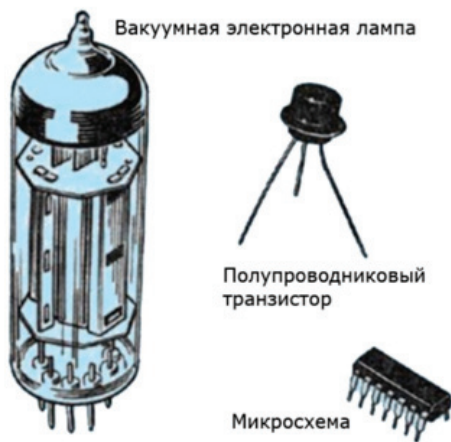
Рис. 1. Элементная база поколений ЭВМ
